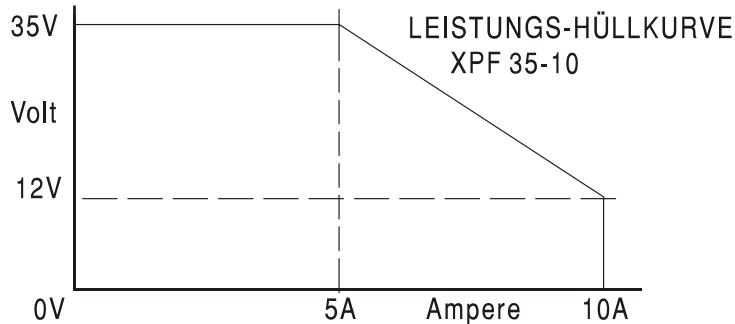
Die Leistungshüllkurve ist so eingestellt, dass unter Versorgungsbedingungen (wenn beide Ausgänge belastet sind) 35V/5A und 12V/10A abgegeben werden. Bei niedrigeren Ausgangsspannungen wird die Ausgangsleistung durch den maximalen Strom von 10A begrenzt.
