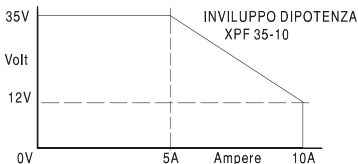
L'involucro di potenza è impostato per dare 35V/5A e 12V/10A sotto tutte le condizioni di carico (ambedue le uscite sotto carico); a tensioni in uscita più basse la potenza in uscita viene ristretta dal limite massimo di corrente di 10A.
