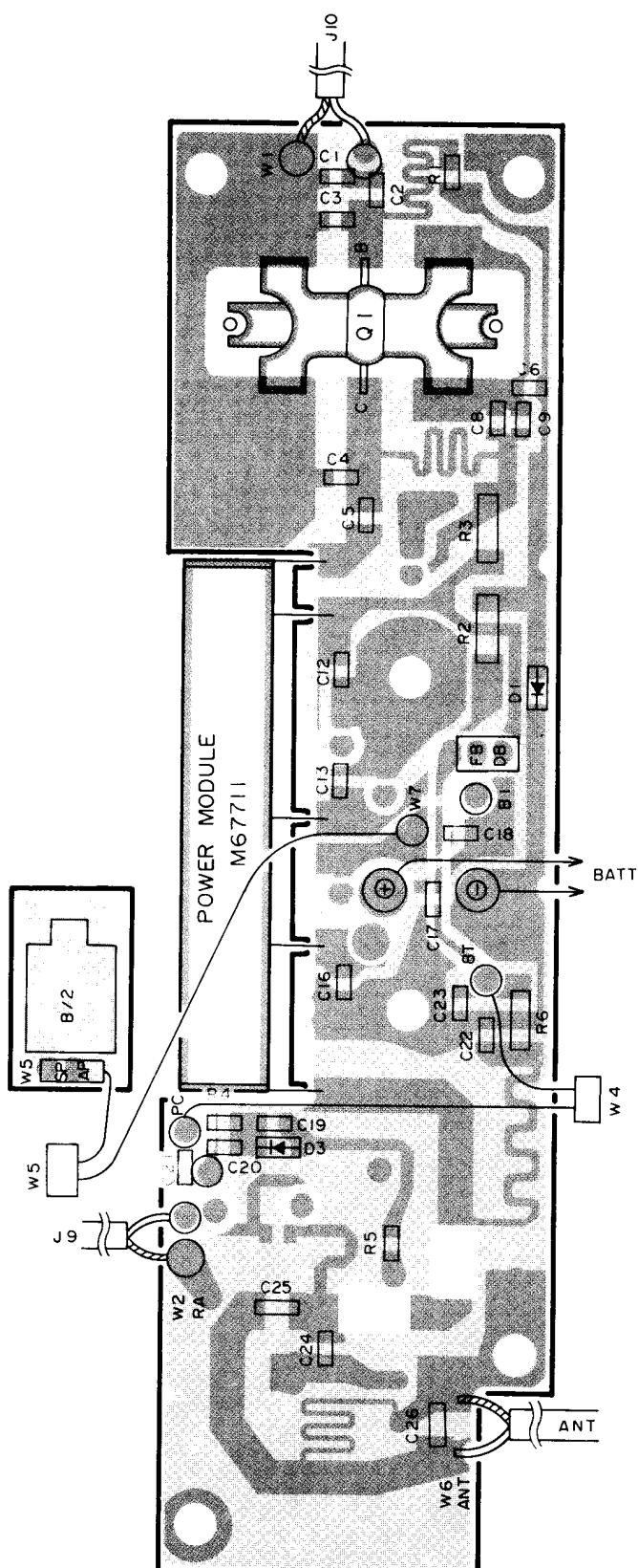
IC1 : M67711 Q1 : 2SC2558K D1 : DLS1585 D2 : DSA3A1 D3 : HSK151 D4,7 : M1407 D5,6 : M1308
